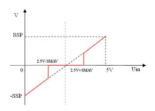
注: 如果死区电压值设置过低,在该端口悬空时,驱动器可能会控制电机以一个很低的速度旋转。
