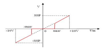
注:如果死区电压值设置过低,在该端口悬空时,驱动器可能会控制电机以一个很低的速度旋转。
