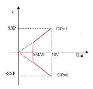
注: 死区电压值如果设置过低,可能在低速区电机转速不稳定。
