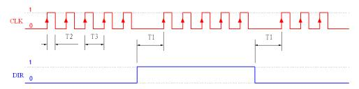
CLK 脉冲频率范围: 0~300KHz。脉冲宽度 T2≥1.5uS, 30%≤占空比≤70%。换向建立时间 T1≥ 1.5mS。
