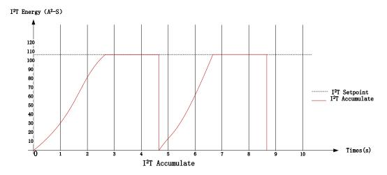
如上图,在 0 时刻,实际电流已经达到最大连续电流 6A, I2T 累加变量开始累加,若实际电流已达到最大峰值电流 SPC 12A, I2T 累加变量未达到设置点(108 A2S),实际电流将被限制到最大峰值电流 SPC12A;当 I2T 累加变量达到 I2T 设置点(108 A2S)时,实际电流被限制到最大连续电流 SCC 6A。在 4.8s 时,IIT 恢复时间到,I2T 累加变量清零并开始新的能量累加,若实际电流已达到最大峰值电流 SPC12A,I2T 累加变量未达到设置点(108 A2S),实际电流将被限制到最大峰值电流 SPC 12A;当 I2T 累加变量达到 I2T 设置点(108 A2S)时,实际电流被限制到最大峰值电流 SPC 12A;当 I2T 累加变量达到 I2T 设置点(108 A2S)时,实际电流被限制到最大连续电流 6A。
