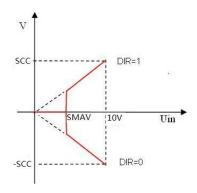
注: 死区电压值如果设置过低,可能在低速区电机转速不稳定。 电机电流和输入电压的关系:
