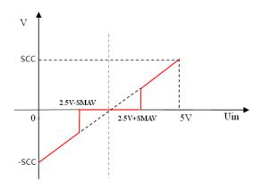
注: 如果死区电压值设置过低,在该端口悬空时,驱动器可能会控制电机以一个很低的速度旋转。 当输入模拟信号电压为 VIN 伏时: 当VIN=2.5V 时, V=0; 当VIN>2.5V 时, 电机正转; 当 VIN<2.5V 时, 电机反转。
